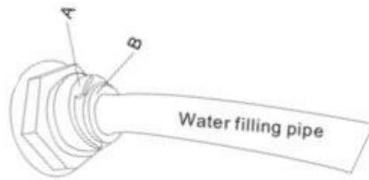
Water filling pipe - Трубка подвода воды
