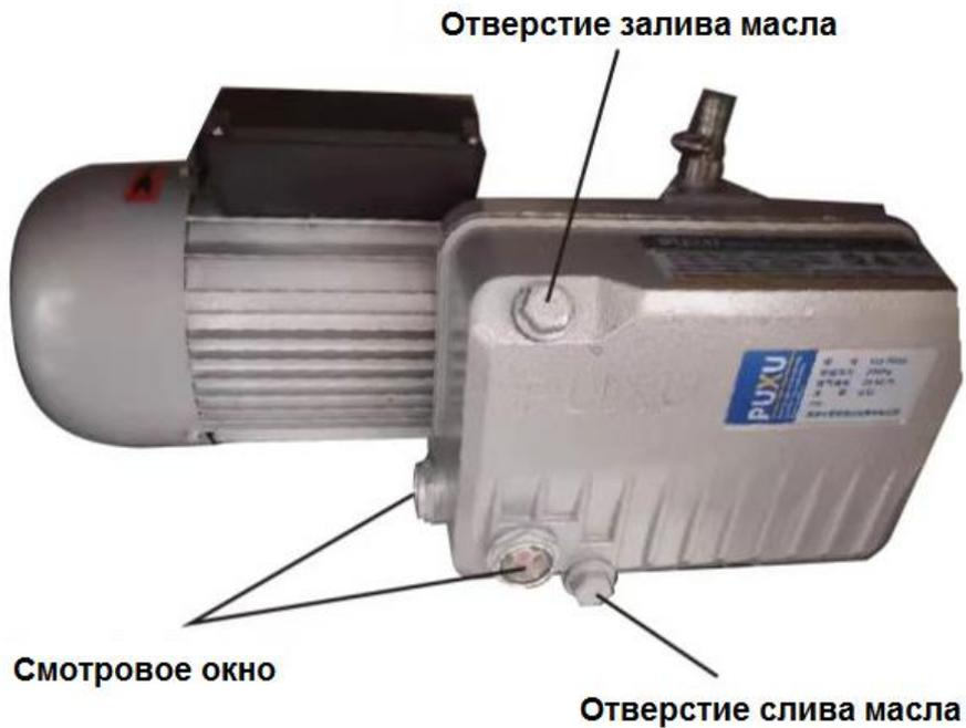
Примечание: перед подключением электроэнергии убедитесь, что напряжение устройства составляет 220 В или 380 В. Если напряжение устройства рассчитано по запросу заказчика, убедитесь, что напряжение такое же, как указано на заводской табличке.
