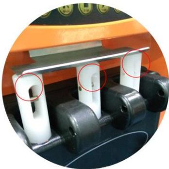
5. По очереди установите ручки на штоки клапанов, медленно проталкивая стальную шпильку через блок подачи и ручки. См. правильное направление ручек на фотографии ниже.
