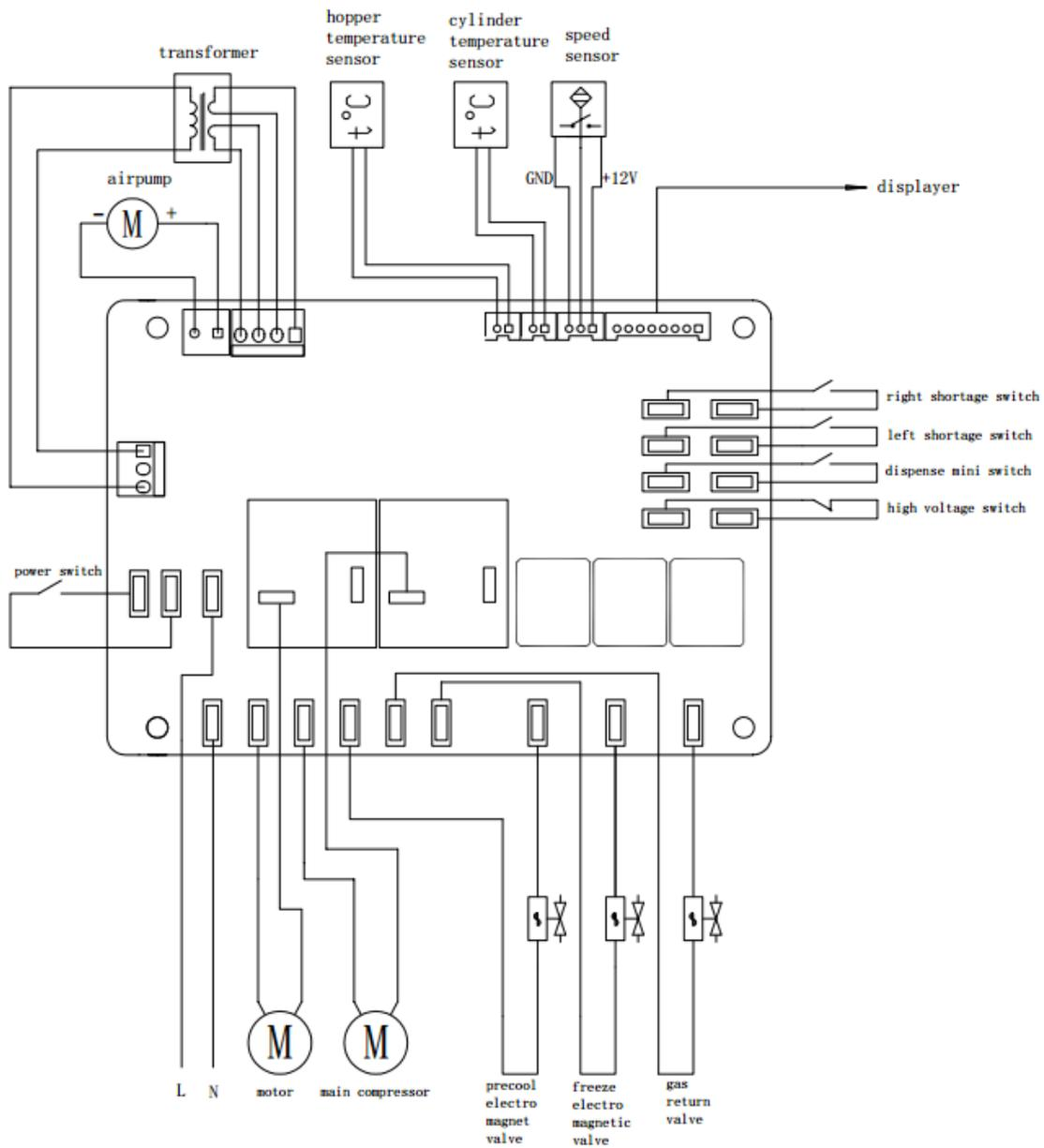
Система предварительного охлаждения с одним компрессором
